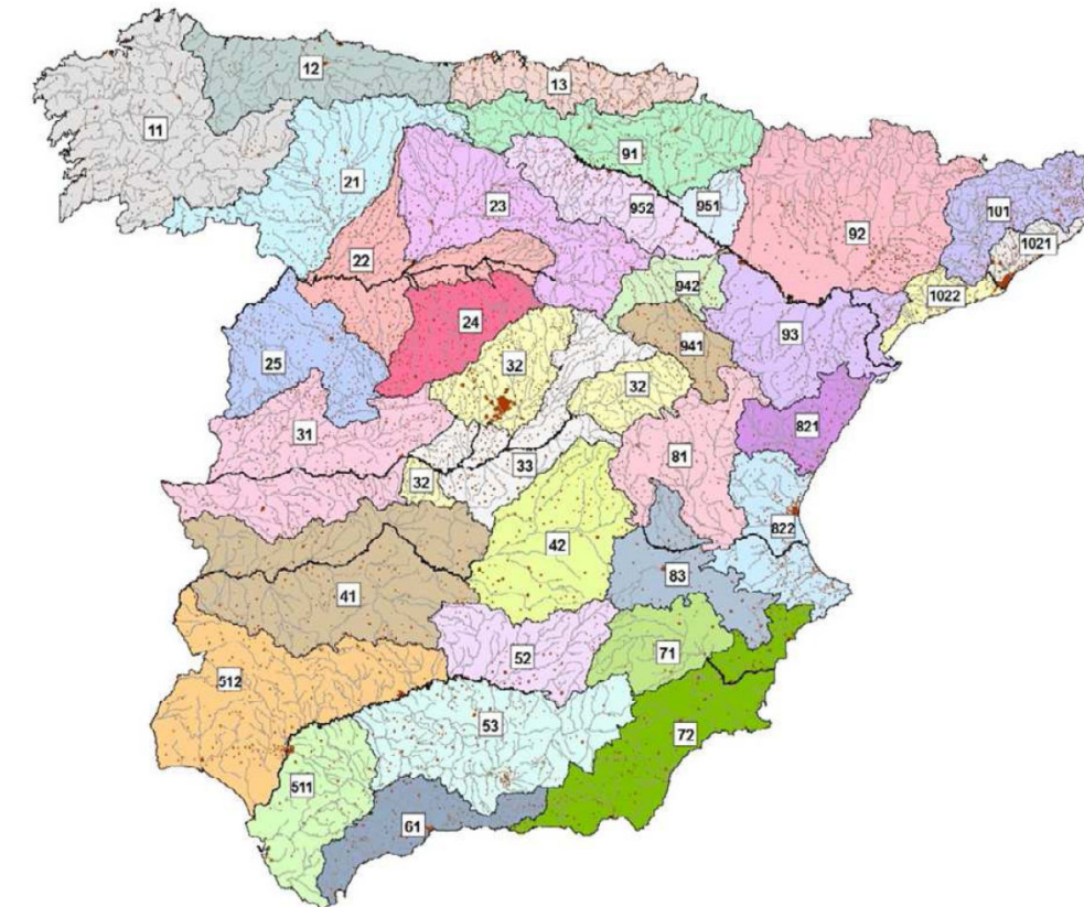
FIGURA 2.9.- REGIONES CONSIDERADAS PARA LA CARACTERIZACIÓN DEL COEFICIENTE CORRECTOR DEL UMBRAL DE ESCORRENTÍA
